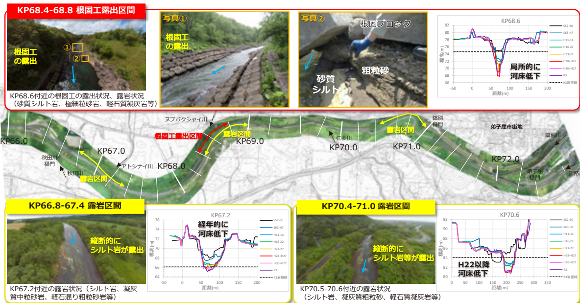
図 2.3 南弟子屈地区における露岩・根固工露出状況、根固工露出区間の現地状況（背景：R4.7 撮影）
