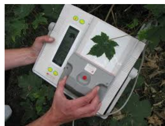
AM350 葉面積計 (英弘精機株式会社製)
