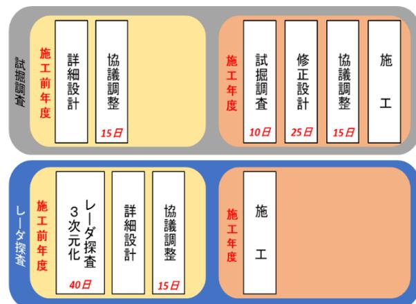
図 4.2 レーダ探査における設計・施工工程例
