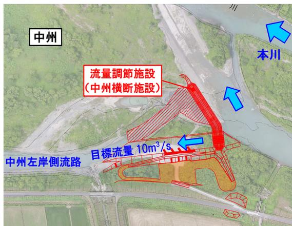
図 3.1 流量調節施設の概念図
