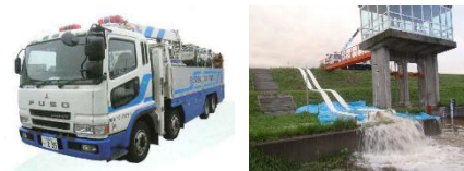
写真 5.2 排水ポンプ車と排水状況事例
