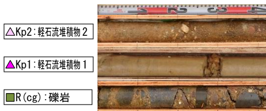
図 3.3 火山灰及び礫岩のボーリングコア状況
