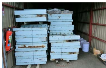
写真 2.1 PCB 含有塗膜が付着している鋼材 (例)
