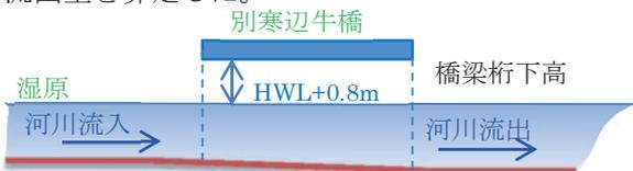
図 3.4 橋梁部の排水モデル
