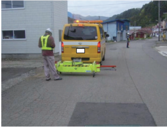
写真 2.3 プロフィールメータ（横断）測定状況
