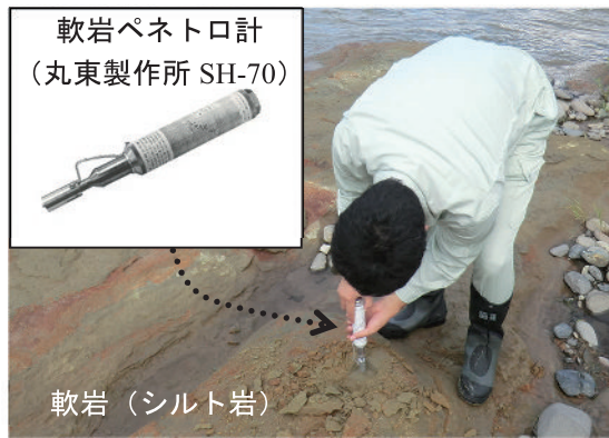
写真 2.1 針貫入試験の実施状況
