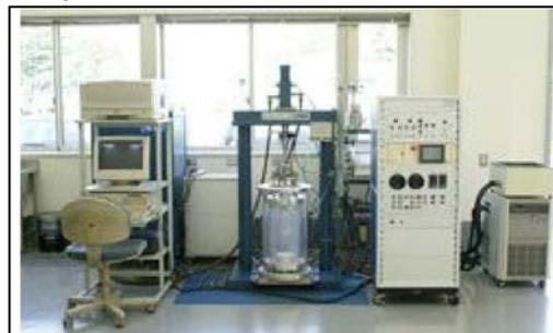
写真-1 繰返し3軸圧縮試験器 前田道路 HP より
