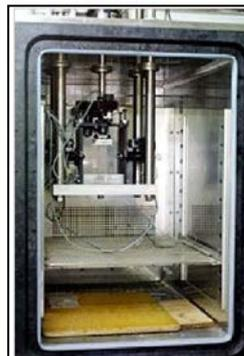
写真-2 繰返し間接引張試験器 大林道路 HP より
