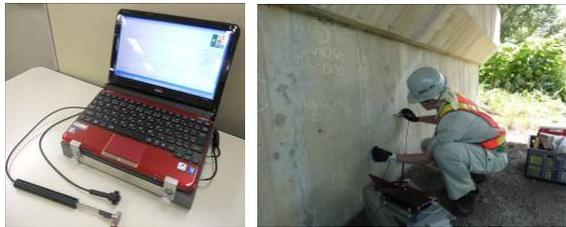
図-7 iTECS 装置および調査状況写真
