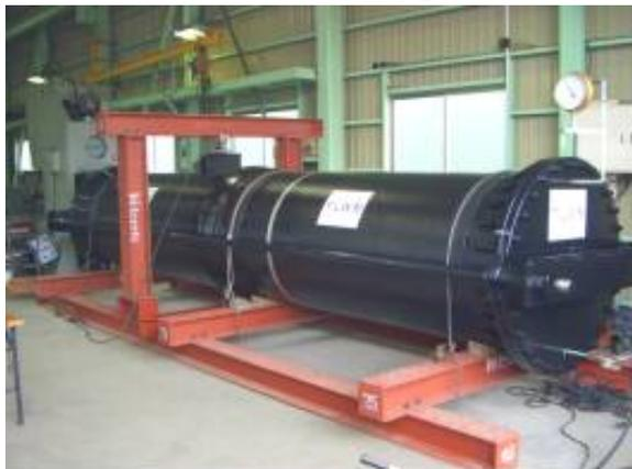
写真-3 水圧試験状況
