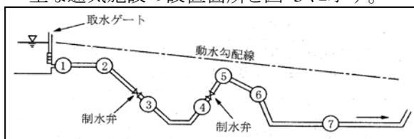
図-3 空気弁及び制水弁の設置位置
