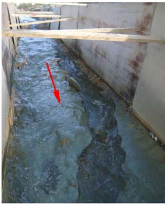
写真-2 実験終了後の水路 (みずみちの形成)
