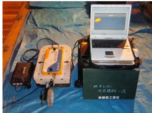
図 2.1 トンネルで使用する地中レーダシステム
