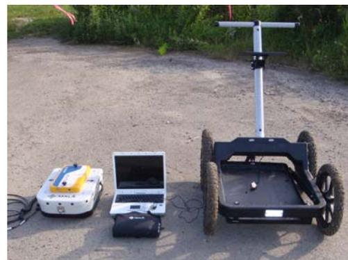
図 2.2 平坦地で使用する地中レーダシステム
