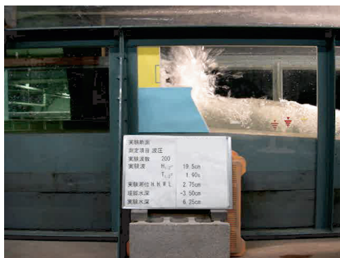
写真-4.1 覆道部波圧作用状況
