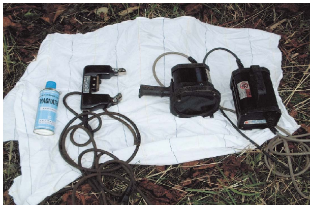
写真-5 磁粉探傷試験機
