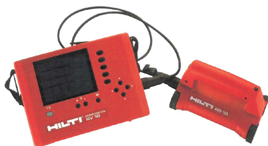
写真-3 鉄筋探査器
