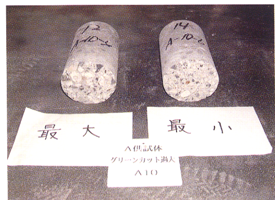
写真9 グリーンカット過大処理破断面
