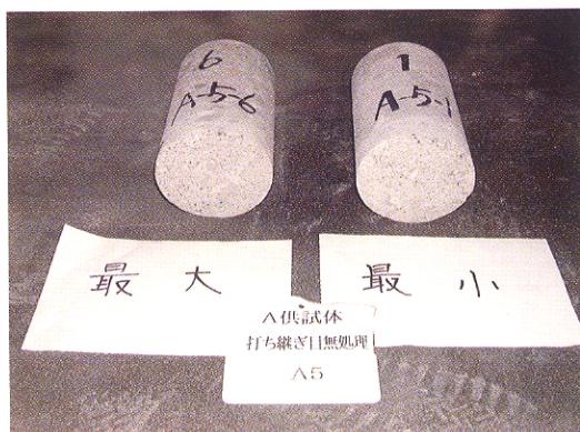
写真8 打継目無処理破断面
