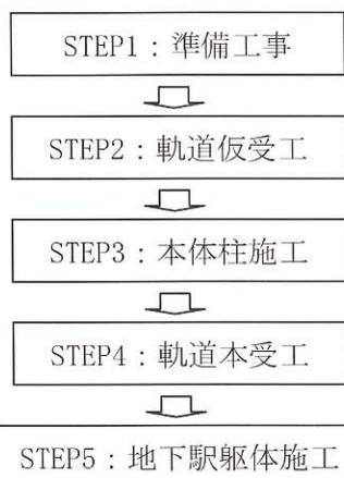
「STEP2：軌道仮受工」は、操重車による工事桁架設工事、工事桁仮受杭の打設、工事桁盛替、既存高架橋の撤去、さらにハイドロフレーズ掘削機による地中連続壁の施工を行っている。
