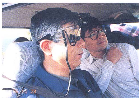
写真-1 アイカメラの試験状況
