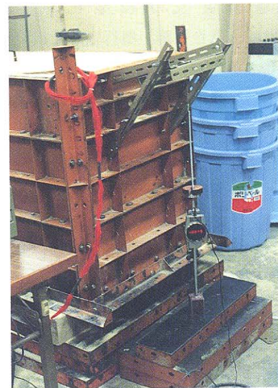
写真-4 静的水平載荷装置
